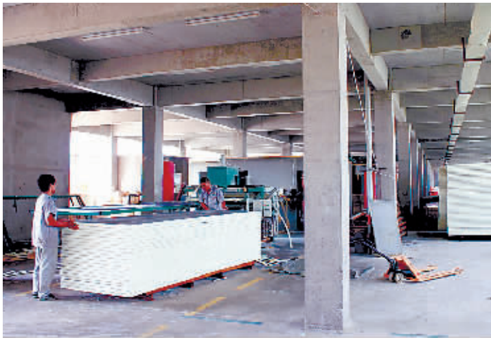
图为烟台同防水保温工程有限公司聚氨酯外墙保温材料生产线。(吴杰摄)
